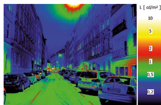
Abb. 27: nach der Umrüstung auf eine gezielte LED-Beleuchtung
